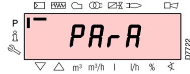
Wählen Sie die gewünschte Parametergruppe mit den Tasten "+" und "-", und bestätigen Sie durch Drücken der Taste "i/reset".
