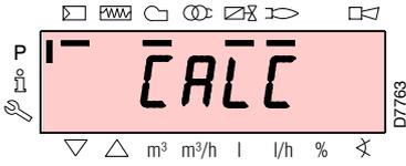
Betätigen Sie nach Einstellung von Punkt "P1" die Taste "+". Auf dem Display erscheint kurzzeitig "CALC": das Steuergerät berechnet automatisch die Punkte von "P2" bis "P8", durch Verteilung auf einer Geraden und Annahme der Werkseinstellung für Punkt "P9" (siehe in nachstehender Tabelle). Diese Daten sind theoretisch und müssen geprüft werden.
