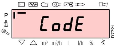
Betätigen Sie gleichzeitig die Tasten "F" und "A" für 1s: auf dem Display erscheint kurzzeitig "Code" und sofort danach 7 Striche, von denen der erste blinkt.
