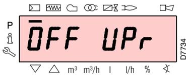
Prüfen Sie, ob das Display des Bedienfeldes die Wärmeabnahme und **“OFF Upr”** anzeigt: dies bedeutet, dass es notwendig ist, die Modulationskurve des Brenners einzurichten.
