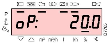
Regeln Sie während der Einstellung jedes Punktes den Luft- und Gas-Stellmotor, ohne jedoch die Position des Gasventil-Stabilisators zu verändern.
