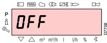
Der Brenner befindet sich im Wartestatus für Wärmeanfrage oder der Schalter "1-0" in Abb. 25 steht auf Position "0".
