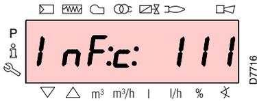
Das Display zeigt abwechselnd einen Code und eine Diagnose des Fehlers an, wobei das System nicht in einen sicheren Zustand versetzt wird.
