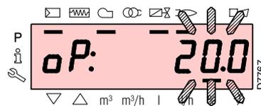
Beim Loslassen der Taste "**F**" erscheint die Standardanzeige mit dem blinkenden Prozentwert der Istbelastung: dies bedeutet, dass der Brenner manuell arbeitet (jegliche externe Regelung wird ausgeschlossen und es sind nur die Sicherheitsvorrichtungen aktiv).
