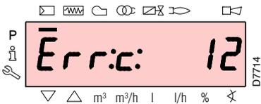
Das Display zeigt abwechselnd den Fehlercode (im nebenstehenden Beispiel **c: 12**) und die entsprechende Diagnose (im Beispiel **d: 0**) an.
