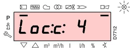
Der Brenner nimmt eine Störabschaltung vor, wenn auf dem Bedienfeld die rote Kontrollleuchte eingeschaltet ist, und das Display zeigt abwechselnd den Störcode (im nebenstehenden Beispiel **c: 4**) und die entsprechende Diagnose (im Beispiel **d: 3**) an.
