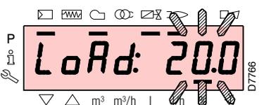
Betätigen Sie die Taste "**F**" für 1 s: es erscheint "**LoAd**" und der Prozentwert der Belastung blinkt.
