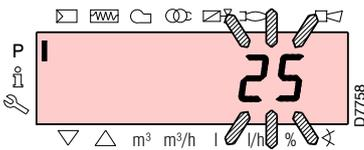
Betätigen Sie die Taste "+" und erhöhen Sie den Wert auf 25 s (blinkend). Betätigen Sie zum Bestätigen und Speichern die Taste "i/reset".
