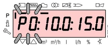
Wählen / geben Sie mit Hilfe der Tasten "+" und "-" den gewünschten Punkt der Kurve ein und warten Sie ab, dass dieser blinkt: dies bedeutet, dass sich die Stellmotoren auf den auf dem Display angezeigten Werten positioniert haben, die dem zuvor eingerichteten Punkt entsprechen.
