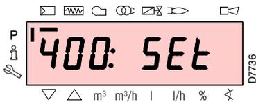
Rufen Sie die Parameterebene gemäß dem *“Verfahren zum Zugang mittels Kennwort”* auf. Das Display zeigt die Parametergruppe **400** an. Bestätigen Sie mit der Taste **“i/reset”**.
