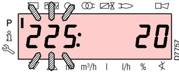
Nach dem Aufrufen der Ebene und der Parametergruppe zeigt das Display links die Nummer des Parameters (blinkend) und rechts den entsprechenden Wert an.
